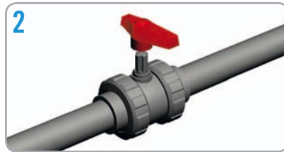
2. Handle dismantling. / Démontage de la manette.
