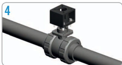
4. Assembly of engine adaptor turret and engine axis connection. / Montage de la tourelle adaptateur moteur et connexion axe moteur.
